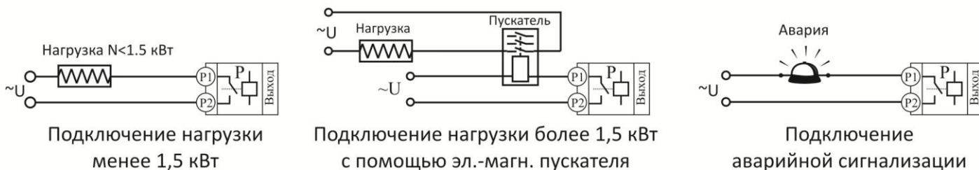
Рисунок 8 – Подключение к релейному выходу
